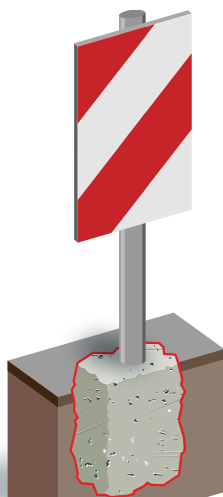
FISSAGGIO DI INSEGNE STRADALI, PALI
